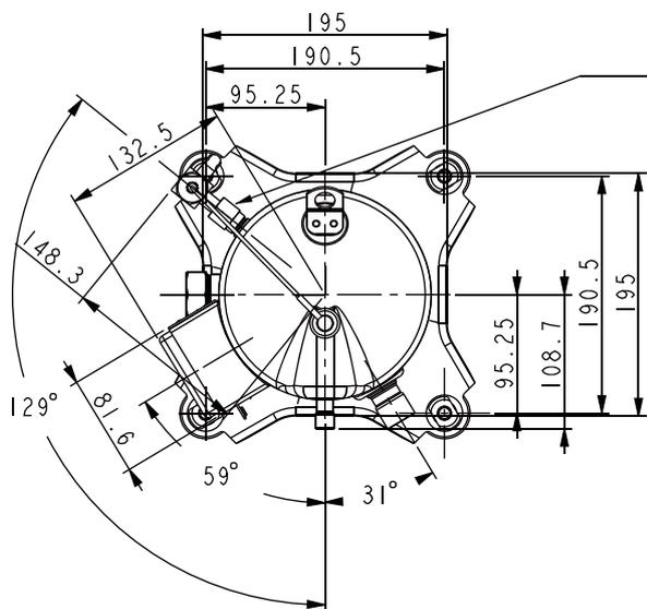
Rotalock-присоединение для впрыска жидкости
