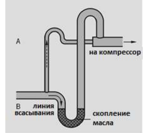
Fig. 11: Вертикальные трубы на стороне всасывания
