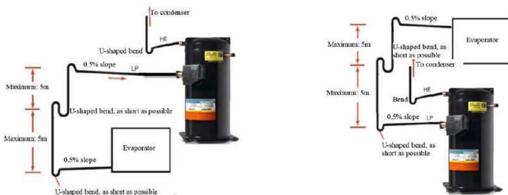
Рис. 5 Установка обратного потока масла
