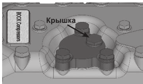
Рис. 20 Состояние при поставке 2 (с завода): Регулятор производительности, смонтирован с кожухом (защита от повреждений при транспортировке).
