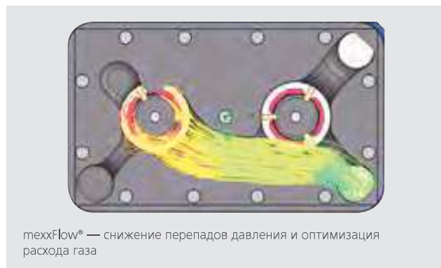
mexxFlow ® в сравнении с прежним исполнением
